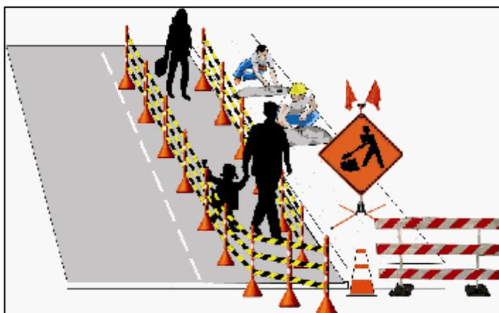
Cuando se adelanten labores de excavación en el frente de obra se debe aislar totalmente el área excavada (delimitar el área con cinta) y fijar avisos preventivos e informativos que indiquen la labor que se está realizando. Para excavaciones con profundidades mayores a 50
